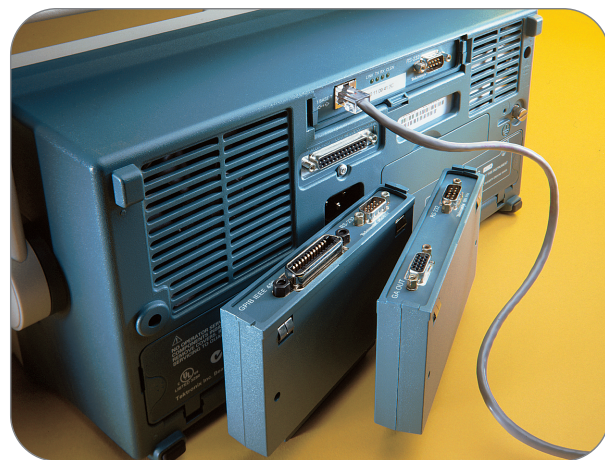
▶ 図 55 TDS3000 シリーズは多様な通信インタフェースに対応します。標準はセントロニクス・ポートですが、オプションでイーサネット /RS-232、GPIB/RS-232、VGA/RS-232 に対応します。
